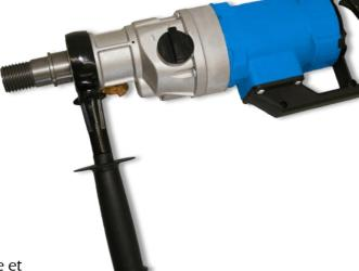
Carotteuse puissante, idéale pour le forage à sec et à l'eau, boîte de vitesses à 2 vitesses avec lubrification à bain d'huile et embrayage de surcharge. Protection moteur et démarrage progressif via Intellitronik.
