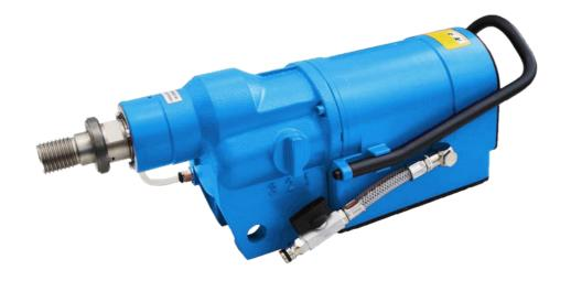
Caractéristiques techniques générales : Référence : W1.SR68 W1.SR68 S SR68 S SR68 Type: Puissance (W): 7500 7500 Tension (V): 400 triphasé 400 triphasé Broche de sortie : 1 1/4" / M33 1 1/4" Poids (Kg): 18,3 14,7 Vitesses de rotation : 140-305 tr/min 260-560 tr/min Plage des diamètres : 120-500 mm 80-350 mm Boîte de vitesses : A bain d'huile A bain d'huile Utilisation à l'eau
