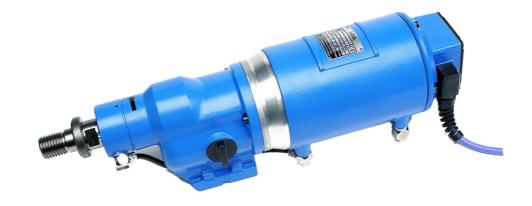
Moteur triphasé extrêmement puissant, refroidi par eau, construction stable grâce au carter entièrement métallique, boîte de vitesses à 3 vitesses avec lubrification à bain d'huile, embrayage de surcharge et pompe à huile.
