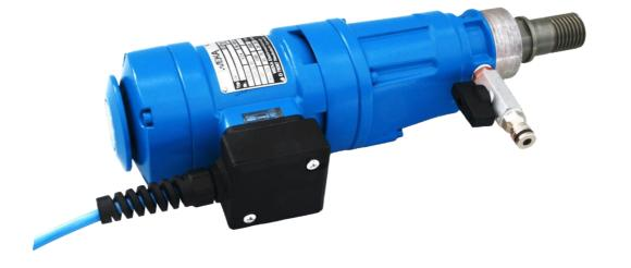
Carotteuse puissante, boîte de vitesses à 3 vitesses avec lubrification à bain d'huile et embrayage de surcharge. Protection moteur et démarrage progressif via Intellitronik. Fixation sur colonne de forage au moyen d'un collier de fixation Ø60 mm
