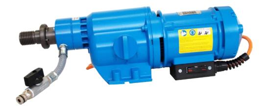
Carotteuse puissante, boîte de vitesses à 3 vitesses avec lubrification à bain d'huile et embrayage de surcharge. Protection moteur et démarrage progressif via Intellitronik.
