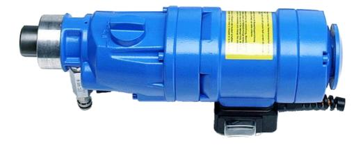
Carotteuse puissante, boîte de vitesses à 3 vitesses avec lubrification à bain d'huile et embrayage de surcharge. Protection moteur et démarrage progressif via Intellitronik. Fixation sur colonne de forage au moyen d'un collier de fixation Ø60 mm
